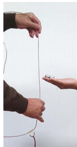
図 4. フレキコイルを上下に持って方位磁針で観察しよう
