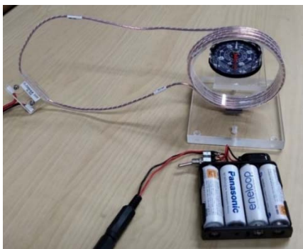
図5. コイルの中の磁界の向きを確かめる
