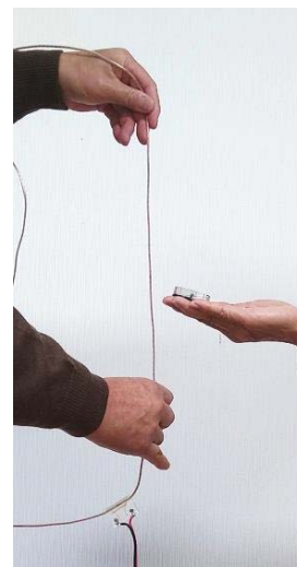
図 4. フレキシコイルを上下に持って方位磁針で観察しよう
