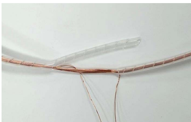
図1. エナメル線を20回巻き、スパイラルチューブを被せた状態
