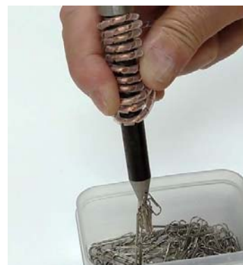
図7. フレキコイルを用いた電磁石
