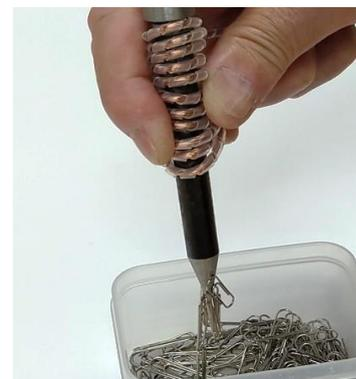
図7 フレキコイルを用いた電磁石
