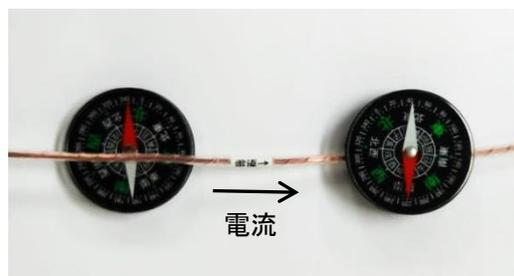
図3 フレキシコイルの上と下の磁針の向き
