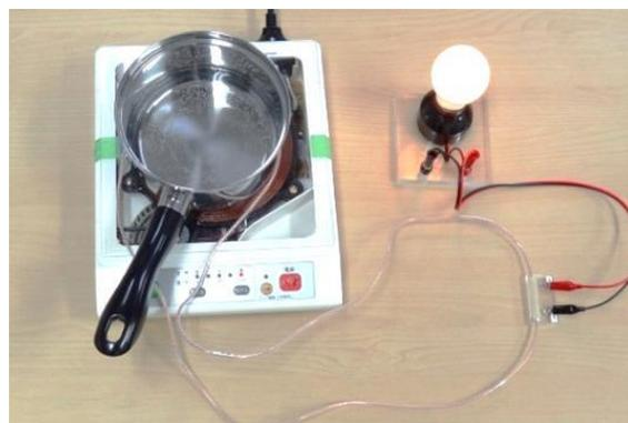
図6 IH調理器を用いた電磁誘導の実験
